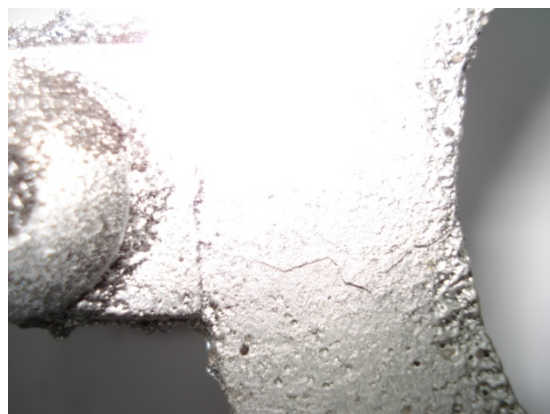
Фиг. 4а Пукнатина, получена при ширина на пръстена 19 мм и пясъчно сърце
