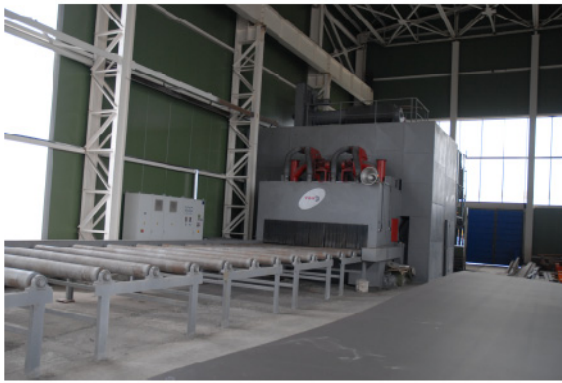
Фиг. 1. Нулева обработка на заготовките
