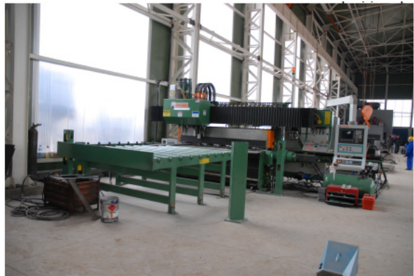
Фиг. 3. Плазмена обработка на заготовките
