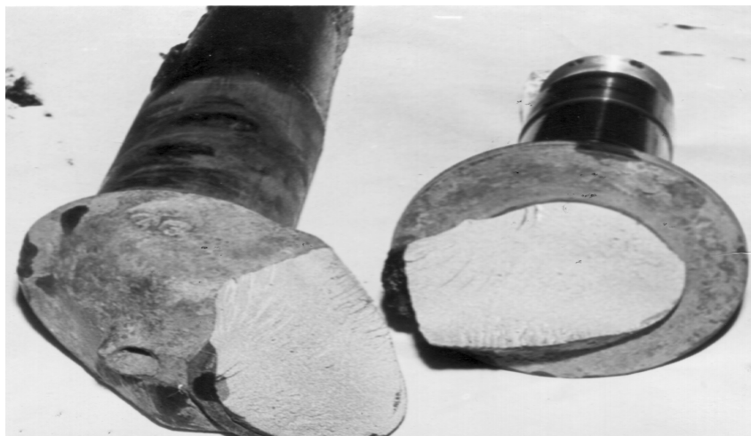
Фиг. 1. Дефектирал детайл “колянова ос” след дълги контролни изпитания на 3738 kт
