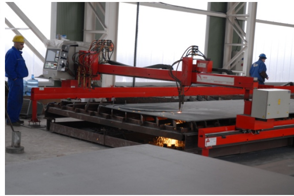
Фиг. 2. Газокислородно рязане на заготовките
