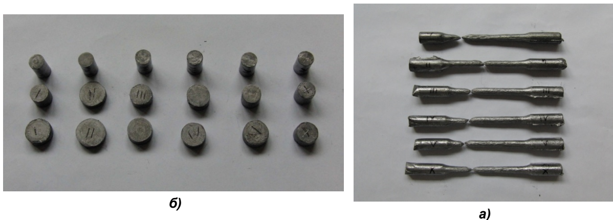
Фиг. 5. Пробни и изпитани образци (от нисколегирани оловни сплави I, II, III, IV, V, X): а) едномерен опън (от горе на долу); б) аксиално сплескване (от ляво на дясно).
