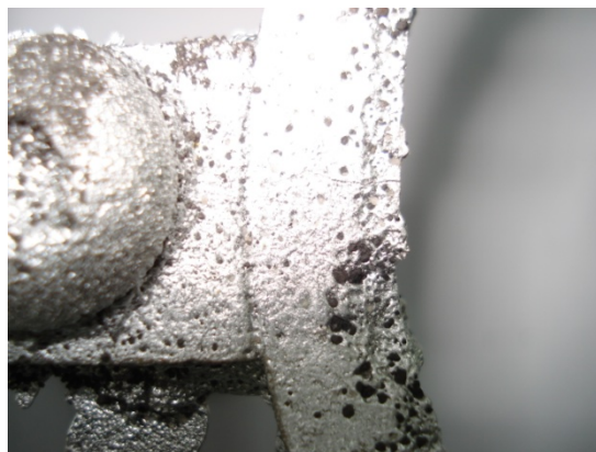
Фиг. 2а. Пукнатина, получена при ширина на пръстена 9 мм и пясъчно сърце
