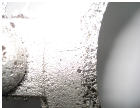
Фиг. 3а. Пукнатина, получена при ширина на пръстена 14 мм и пясъчно сърце
