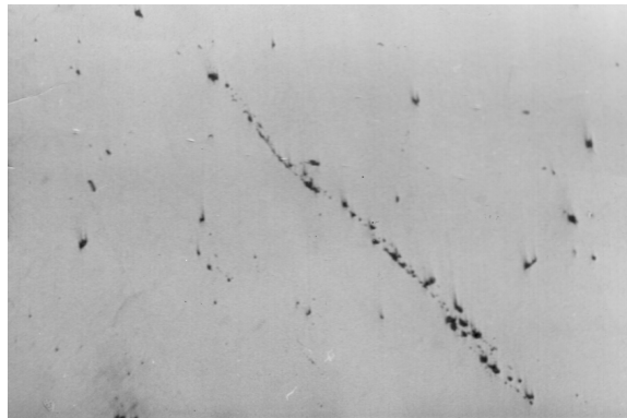
Фиг. 3. Микроструктура с неметални включвания
