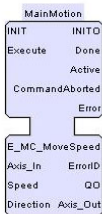
Фиг. 7. Управление на подавателно движение по една ос чрез функционални блокове
