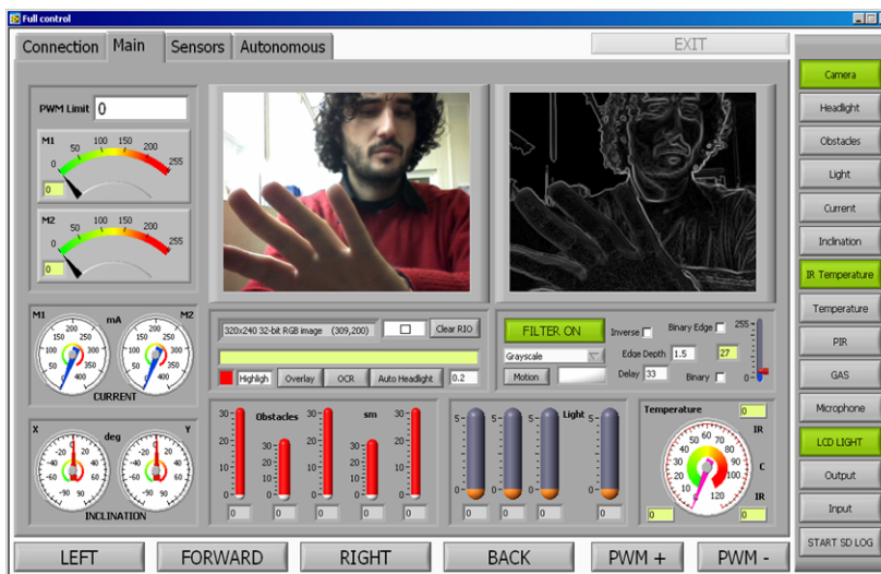
Фиг. 4. Главно меню и активиран edge detection във входящото изображение от камерата на робота. Видео обработката е в реално време
