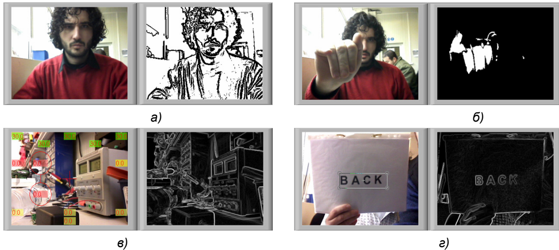
Фиг. 5. Операции върху изображението: а) бинаризация на ръбова; б) детектор за движение; в) визуализиране на информация върху картината и edge detection; г)
