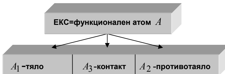
Фиг. 1. Схема на функционалния атом на трибологията
