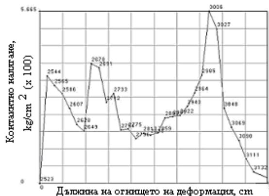
Фиг. 8. Разпределение на контактното налягане в огнището на деформация на кл.1
