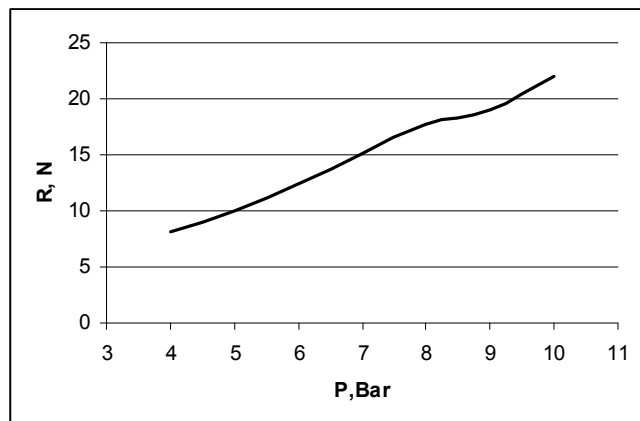
Фиг. 6. Изменение на силата R в зависимост от налягането на въздуха
