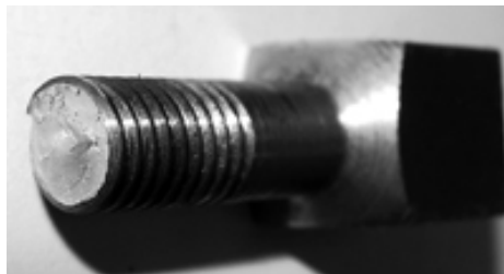
Фиг. 8. Разрушен образец от стомана S960QL
