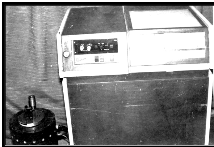
Фиг. 1. Вибростенд за циклични трайностни изпитания и определяне границата на умора на материала "ВИА 300" НПЛПМКМ-БАН
