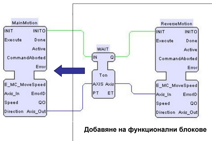
Фиг. 8. Добавяне на основни функционални блокове в приложение “главно движение”
