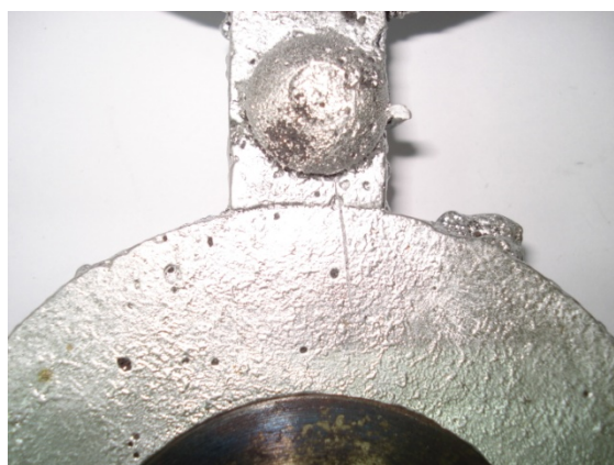
Фиг. 5а. Пукнатина получена при ширина на пръстена 24 мм и метално сърце
